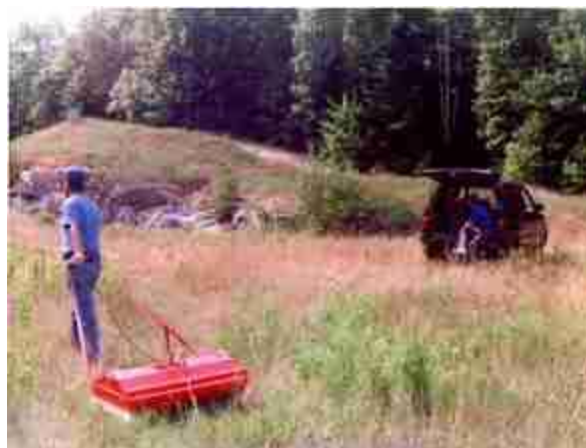
Εικόνα 3 Η κεραία των 100 Mhz σε monostatic mode δηλαδή πομπός και δέκτης μαζί για βάθη μέχρι 15 μέτρων.
