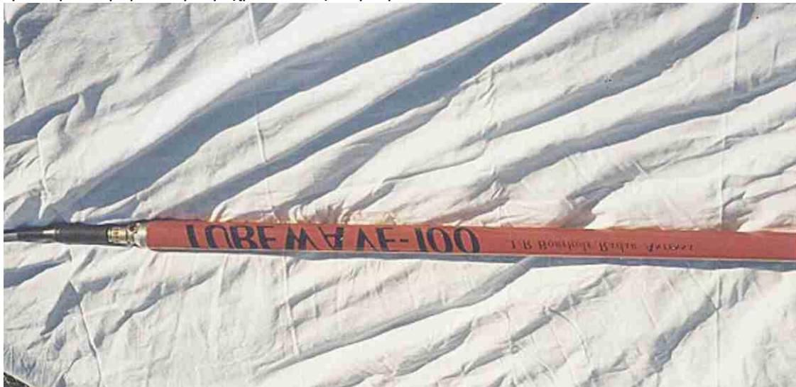
Εικόνα 5 Η κεραία αυτή κατεβαίνει σε γεωτρήσεις και με κατευθυνόμενη εκπομπή μπορεί να ελέγξει περιμετρικά (360 μοίρες) σε ακτίνα 15 μέτρων
