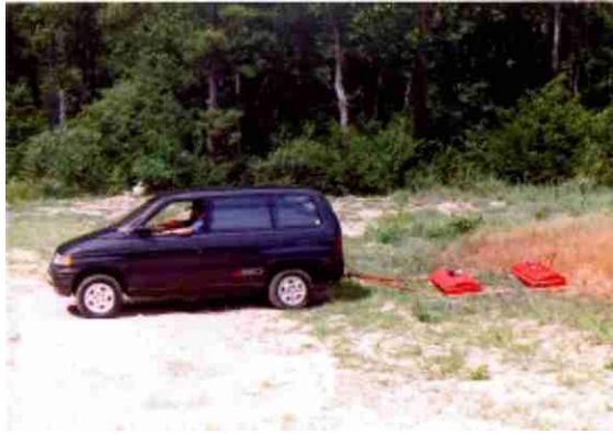
Εικόνα 4 Η ίδια κεραία (των 100 Mhz) με ξεχωριστό δέκτη και πομπό έχει την δυνατότητα να ερευνήσει την γεωλογία μέχρι βάθους 25 μέτρων.
