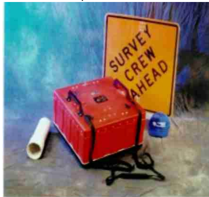
Εικόνα 2 Η κεραία των 200 Mhz που χρησιμοποιείται για βάθη μέχρι 15 μέτρων για γεωτεχνικούς κυρίως σκοπούς
